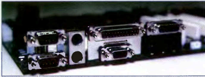
Rys. 2. Panel I/O. Na górze schemat ze specyfikacji Intel'a, na dole przykład panelu z płyty ATX ASUSa.
